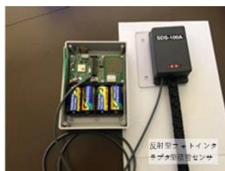
第 2 世代送信ノード端末と積雪計
