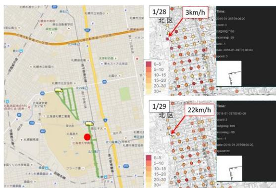
図3 1月28日～29日にかけて行われたコーナー重点除排雪の経路と、作業前後の交通状況の可視化（右上：作業前、右下：作業後、図では同じコーナーの左折の平均速度の改善を示している。
